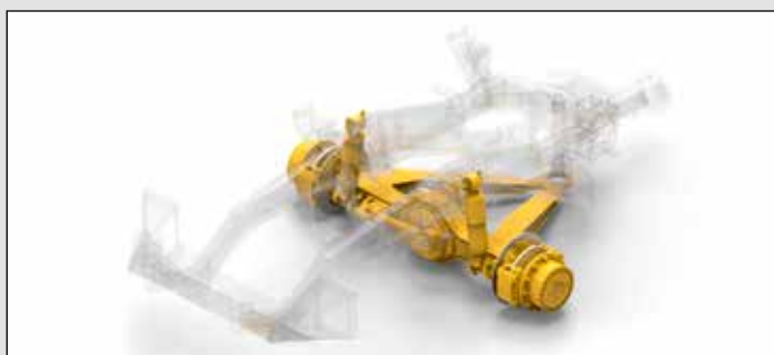
А-образная рама передней подвески оснащена гидропневматическими стойками, снижающими воздействие на самосвал неблагоприятных дорожных условий. Улучшенная подвеска сидения обеспечивает снижение нагрузок на оператора.
